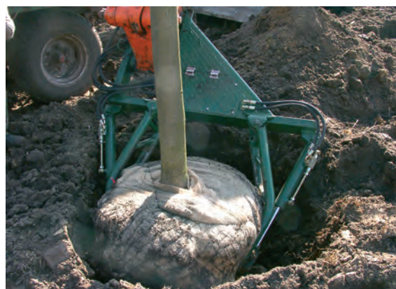
Bei schweren Ballen ist die Verwendung der auf Anregung von arbo neu entwickelten dreidimensional steuerbaren arbohand von Kreye, Bad Zwischenahn, die schnellste und eleganteste Lösung, den Baum aus jeder Ausgangslage vertikal zu pflanzen.
