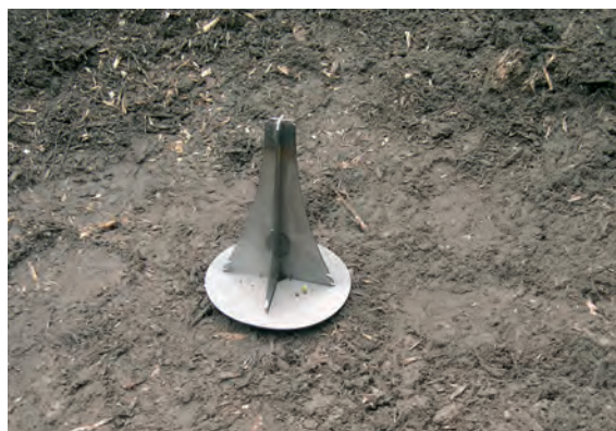
Wenn man genau zielt, kann man natürlich auch den Ballen auf den arbofix heben. Der Baum drückt dann mit seinem Eigengewicht das System durch den Ballenring. Lehmballen sollten immer etwas durchfeuchtet sein, damit die Eindringung eleganter gelingt.
