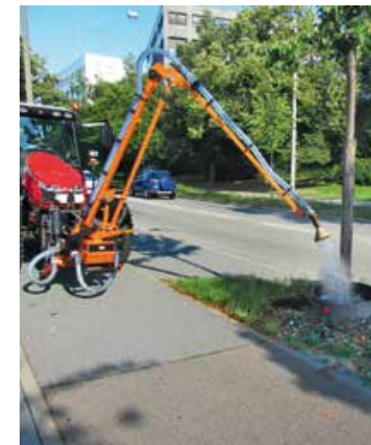
Schnellste Befüllung des arboGreenWell - ohne Absteigen, selbst mit Brausenkopf.
